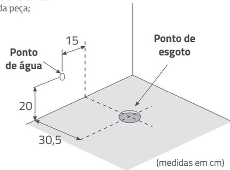
O ponto de esgoto fica a 30,5 cm da parede acabada, com tubo de 4" (100 mm) de diâmetro.
