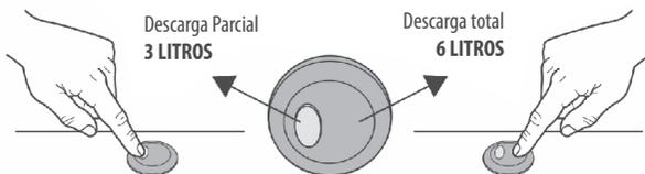
\* O Mecanismo de saída com sistema de **Duplo Acionamento** possui ação independente para duas funções: **descarga total** e **descarga parcial**.
