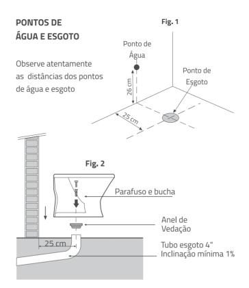
Fig. 1 – Deixar a conexão para a entrada de água da bacia a 26 cm do piso acabado. Deixar o ponto de esgoto a 25 cm da parede acabada. Corte o tubo rente ao piso ou deixe-o sobressair no máximo 1cm acima.
