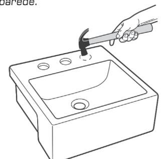
**02** Marque o local de passagem dos engates flexíveis para entrada dágua quando utilizar misturadores acoplados na mesa de metais da cuba.
