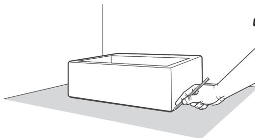
**01** Posicione a peça sobre o tampo na posição que se deseja instalar, considerando o posicionamento das torneiras e saída de esgoto. Marque no tampo onde será efetuada a saída da esgoto, como também o contorno da peça, verificando o paralelismo com a parede.
