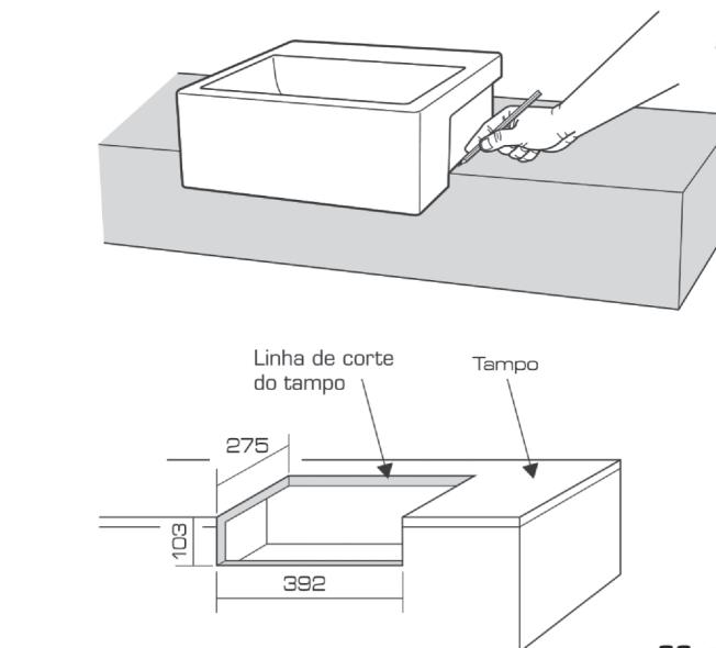
**01** Posicione a peça sobre o tampo na posição que se deseja instalar, considerando o posicionamento das torneiras e saída de esgoto. Marque no tampo onde será efetuada a saída da esgoto, como também o contorno da peça, verificando o paralelismo com a parede.
