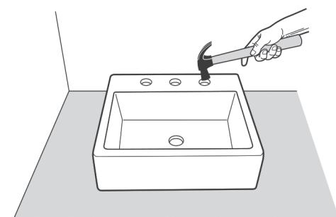
**03** Quando for utilizar misturadores acoplados à mesa da cuba, deve-se proceder a abertura dos semifuros batendo -se da parte esmaltada para baixo
